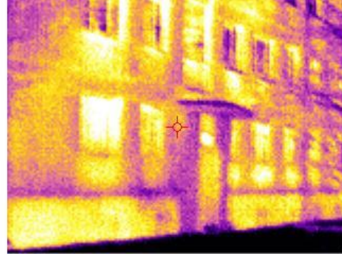
Vundament tuleks kindlasti niiskustõkkega varustada ja soojustada juhul, kui seintele lisasoojustus paigaldatakse.
